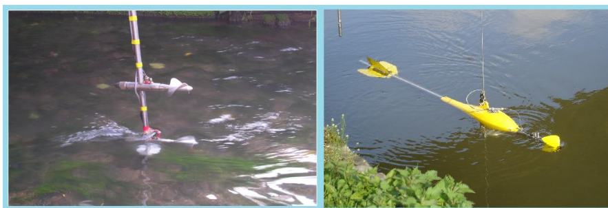
Figure 41 – Jaugeage à l'aide d'un moulinet à gauche et jaugeage au saumon à droite
