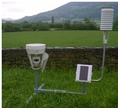
Figure 43 - Pluviomètre (à gauche) et thermomètre (à droite)
