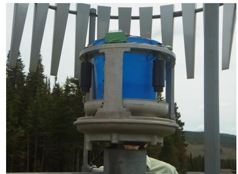
FIGURE 3.6 – Précipitomètre à pesée de la Station Principale
