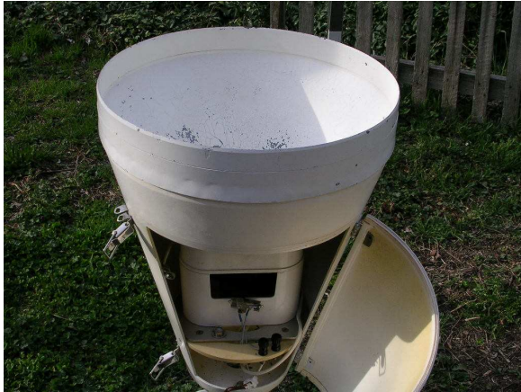
Figure 6 : photo d'un pluviomètre à balancier (source : http://www.meteodesorres.com )
