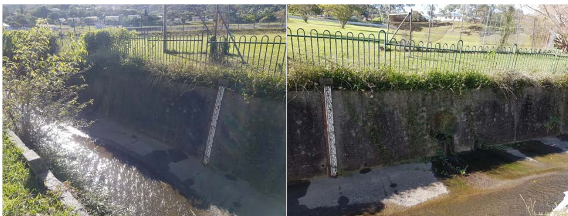
Figure 18 : Perturbations sur la mesure de débit à la station de la Namie
